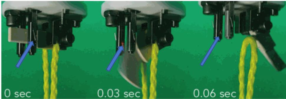
蓝色标志指示为熔断丝，整个过程代表“熔断丝固定”-“熔断丝熔断”-“锚系释放”三个过程。
